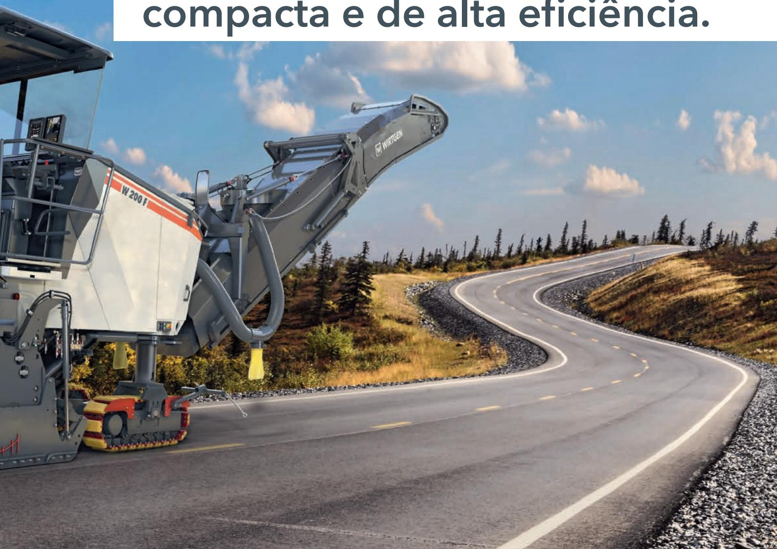
A fresadora a frio, compacta e fácil de operar, atende a uma ampla gama de aplicações, desde a reabilitação de solo pela remoção de pavimento em profundidade total até operações de fresagem fina.
