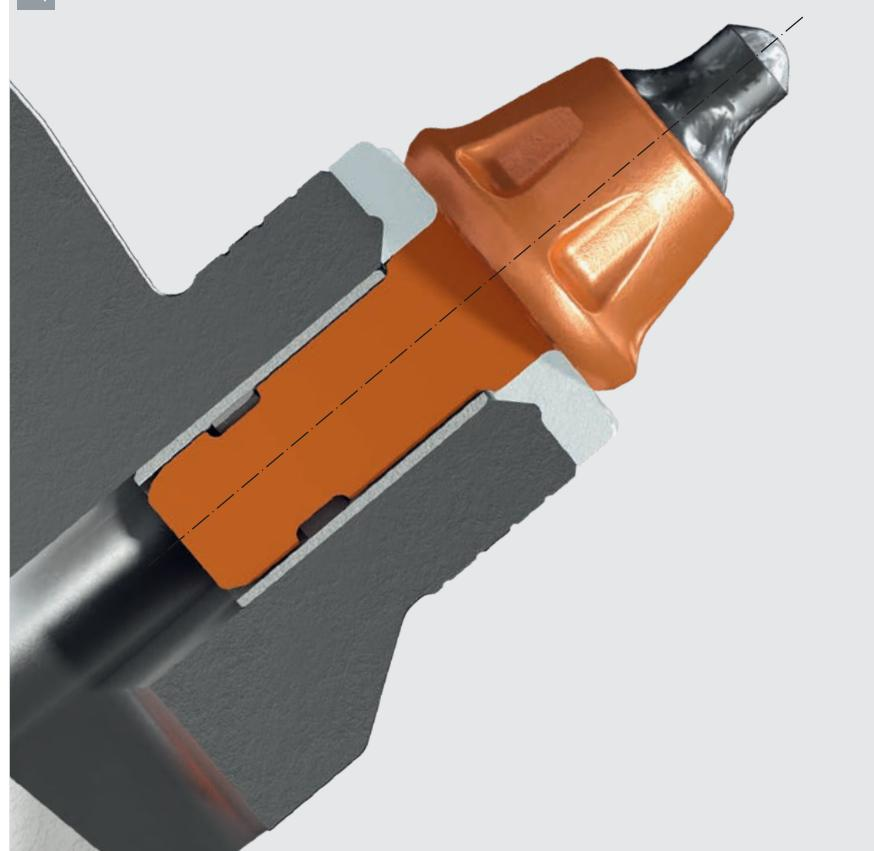
**3 |** Em combinação com o novo bit, o relevo de centralização no novo porta-ferramentas optimiza a rotação para reduzir o desgaste.
