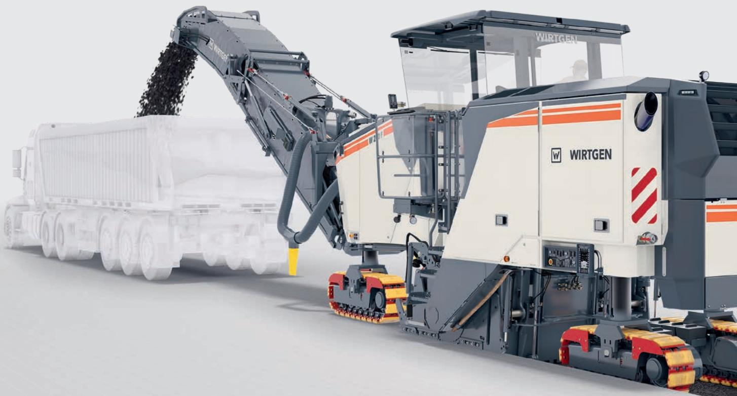
1 | **Amplos ângulos de giro do transportador de descarga**
