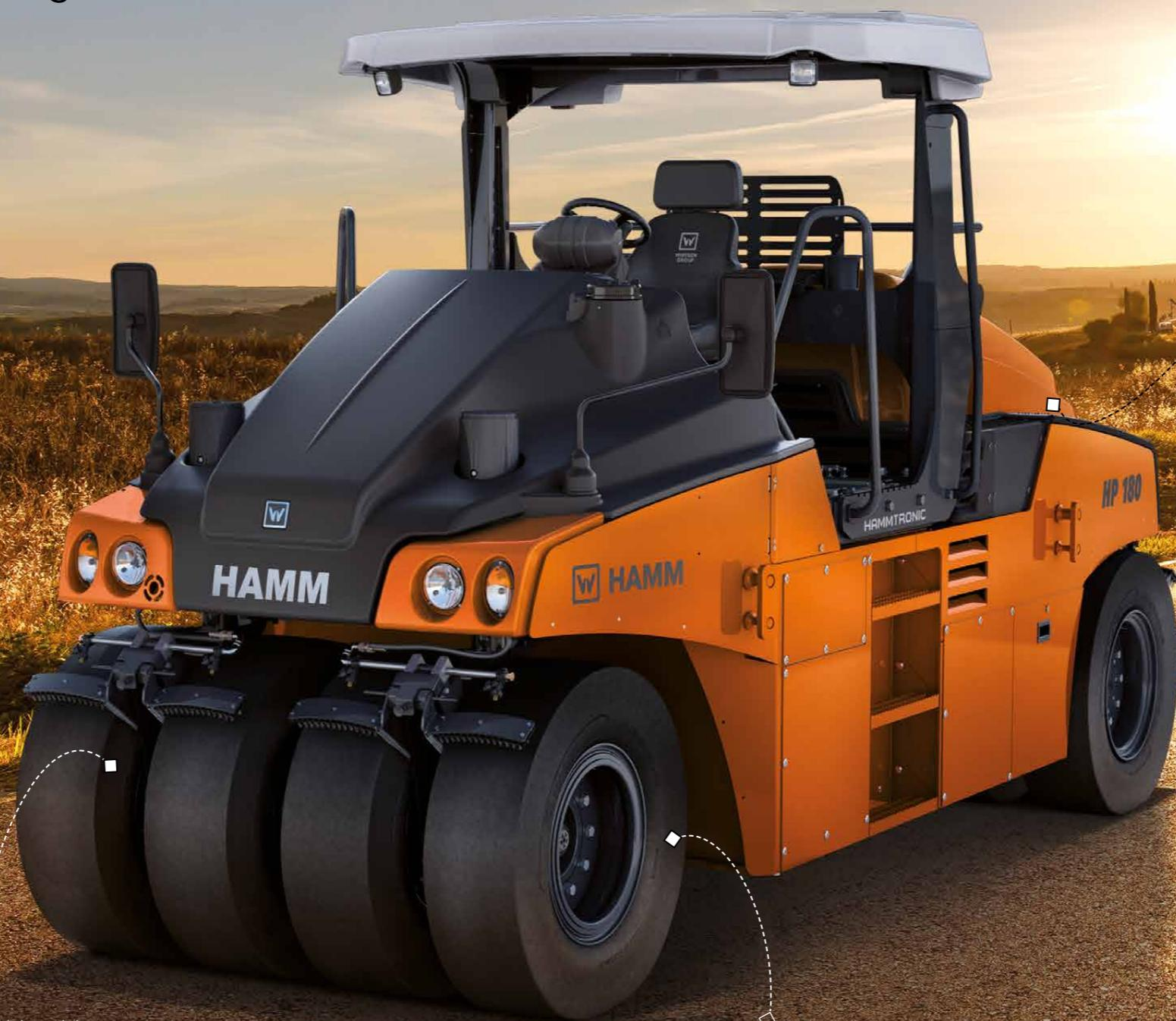
El diseño inteligente del eje delantero garantiza la compensación del nivel de las ruedas en todo momento y, por consiguiente, la distribución uniforme de la carga sobre el terreno.
