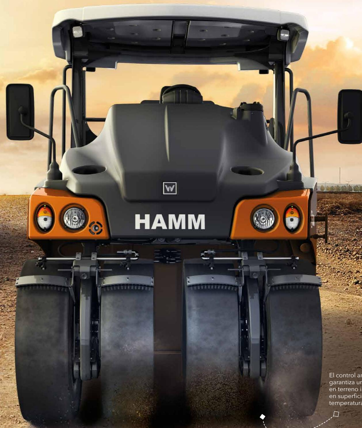
El control antideslizamiento garantiza una tracción óptima en terreno irregular, así como en superficies con distintas temperaturas.
