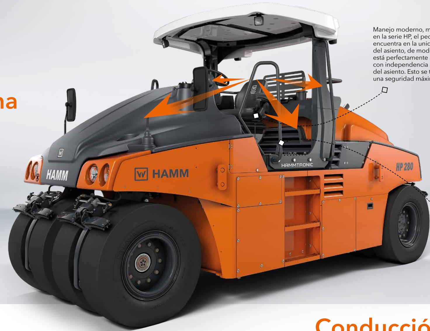
Manejo moderno, manejo seguro: en la serie HP, el pedal de freno se encuentra en la unidad de mando del asiento, de modo que siempre está perfectamente al alcance, con independencia de la posición del asiento. Esto se traduce en una seguridad máxima.
