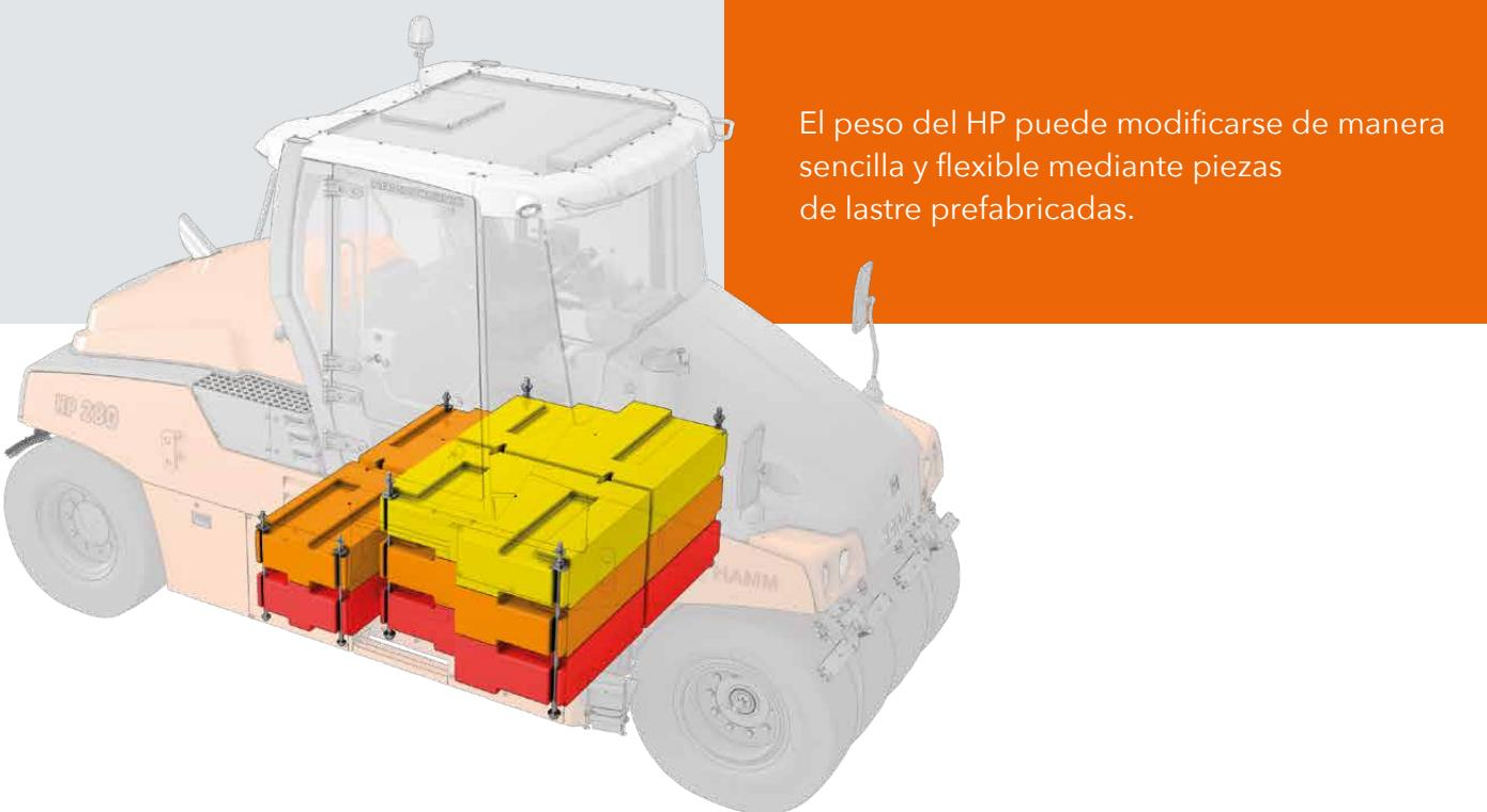
El peso del HP puede modificarse de manera sencilla y flexible mediante piezas de lastre prefabricadas.
