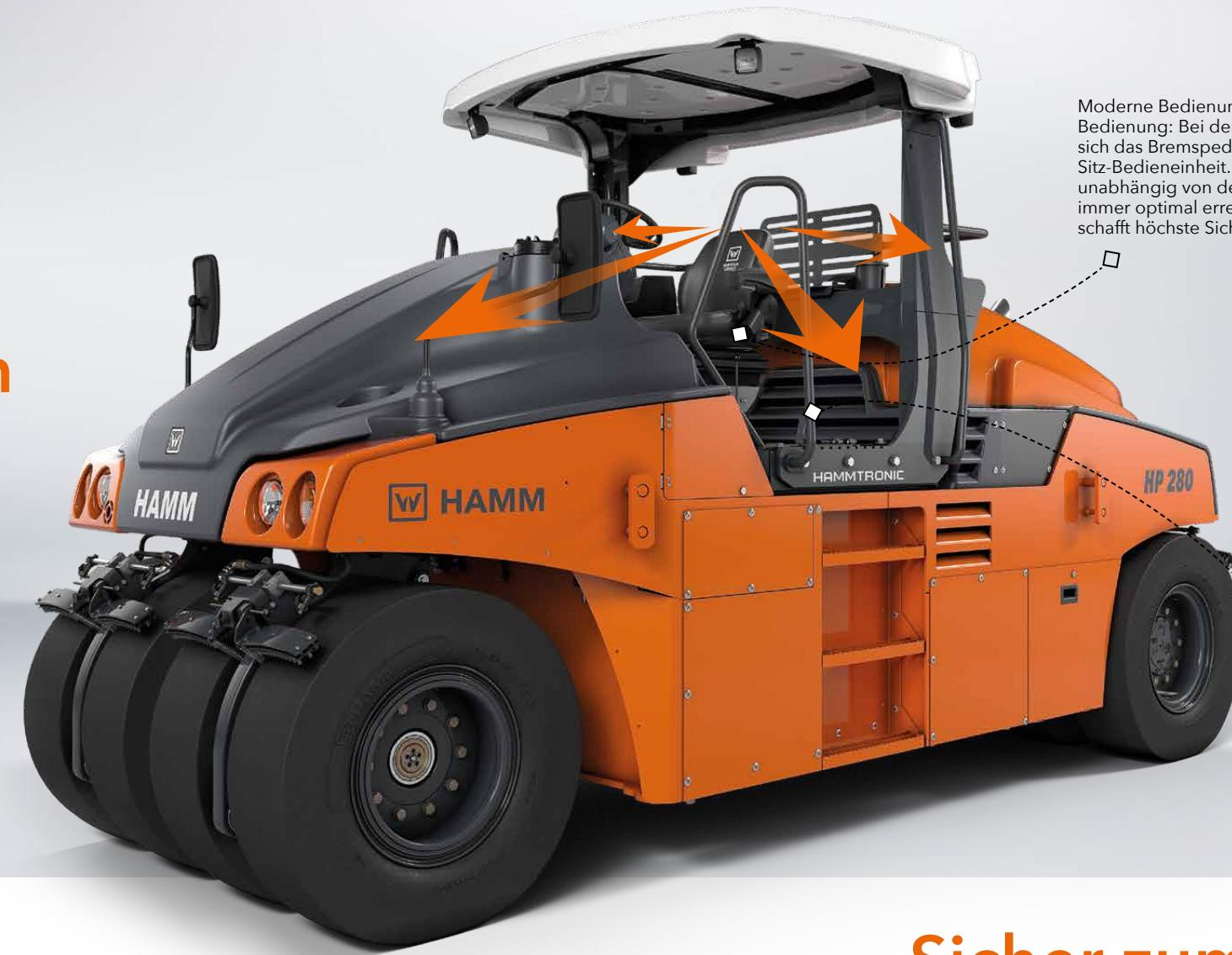
Moderne Bedienung – sichere Bedienung: Bei der HP befindet sich das Bremspedal an der Sitz-Bedieneinheit. Damit ist es unabhängig von der Sitzposition immer optimal erreichbar. Das schafft höchste Sicherheit.
