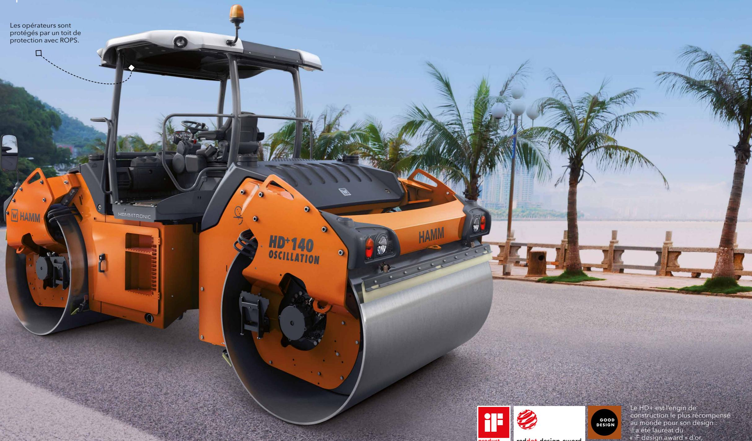
Les rouleaux de la série HD+ sont entièrement conçus pour maximiser le rendement : ils disposent de réservoirs volumineux, de cylindres à grands diamètres et de systèmes d' entraînement et de vibration ou oscillation performants. Grâce à Hammtronic et à de nombreuses autres solutions intelligentes, les machines HD+ sont très économies. Ces rouleaux sont ainsi la solution idéale pour un compactage efficace de grandes surfaces.
