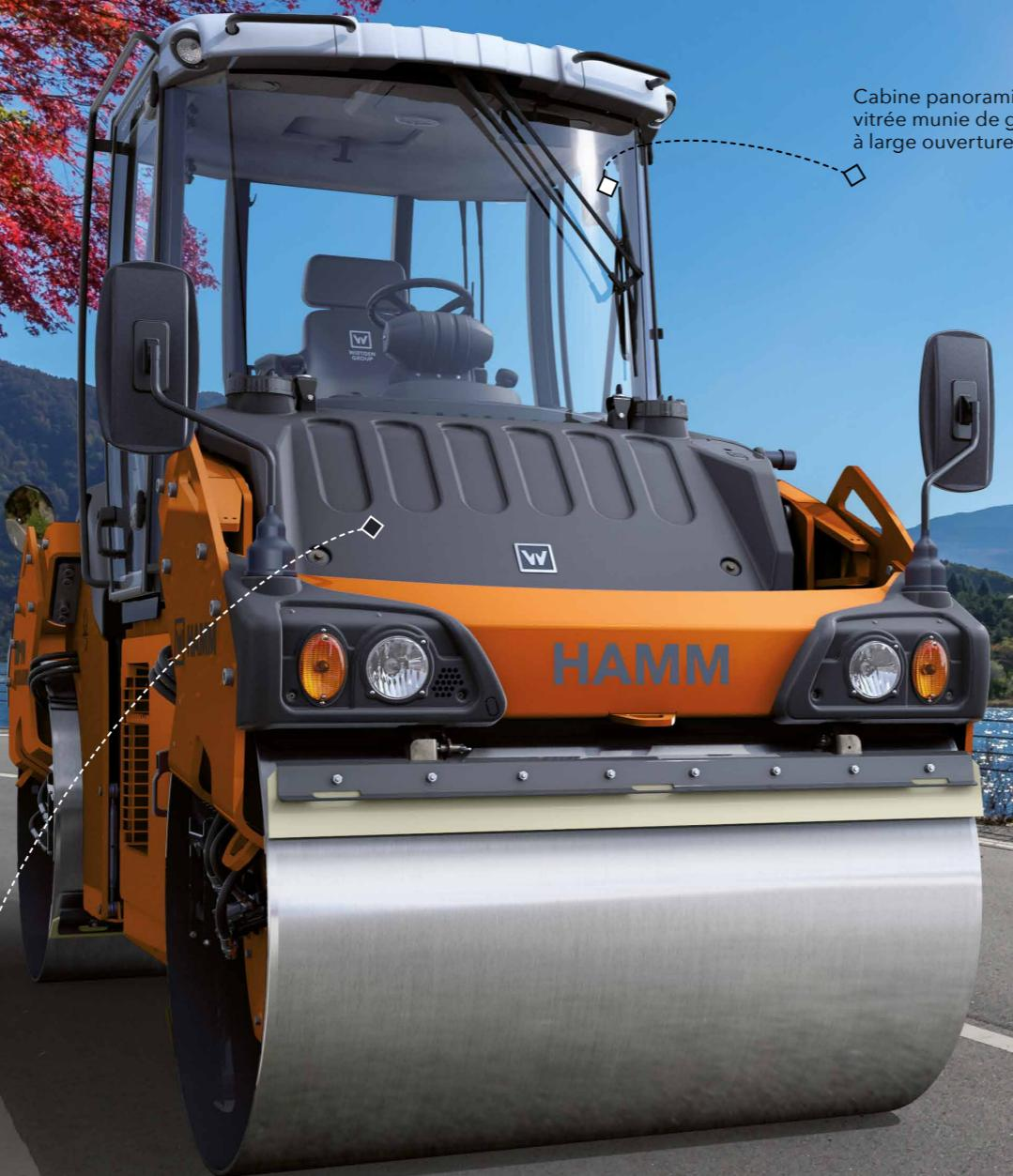
Le châssis ouvert et la forme des réservoirs offrent une vue dégagée sur l'espace qui se trouve juste devant les cylindres.
