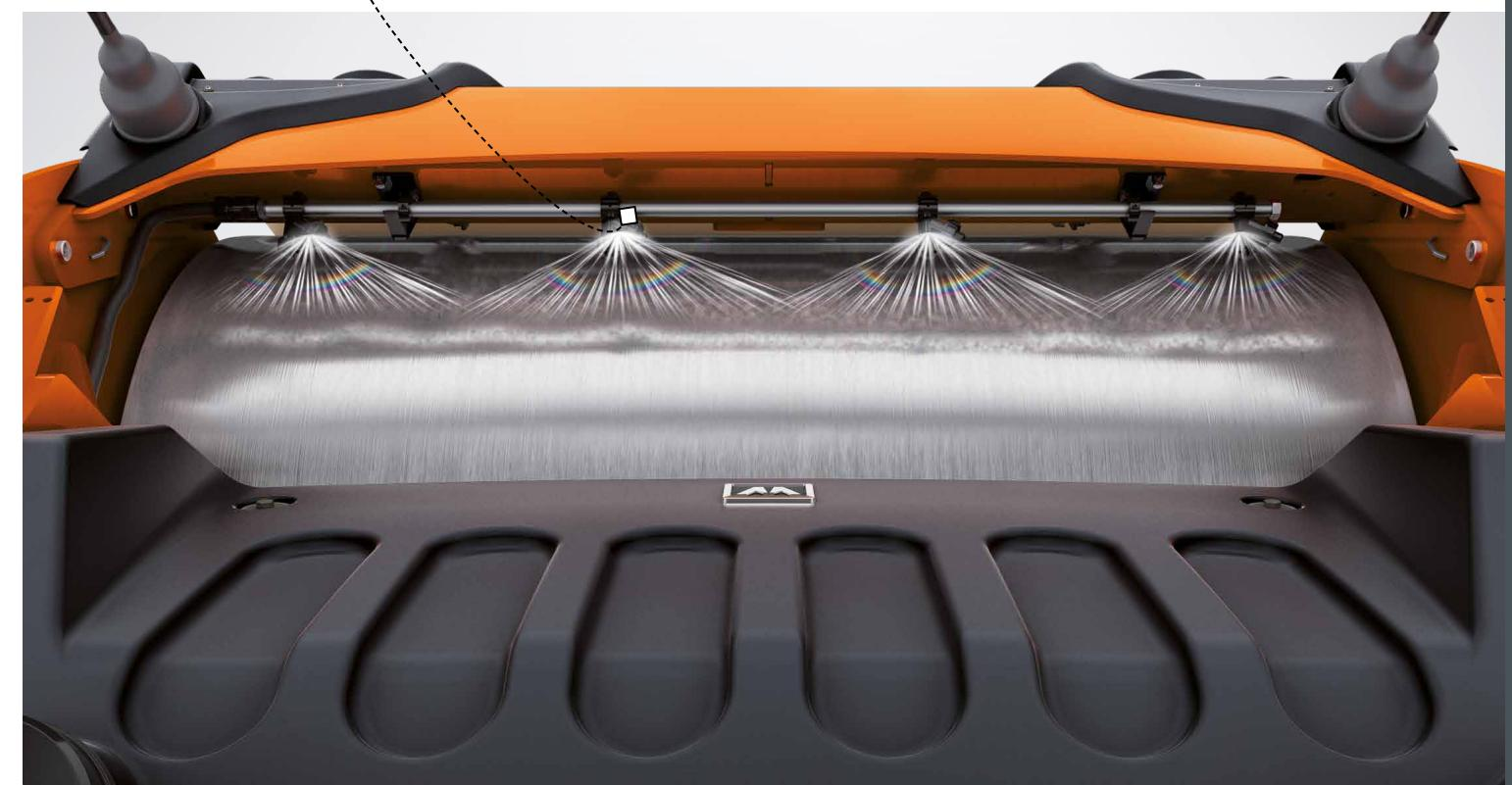
La perfecta interacción de la articulación central, los accionamientos de vibración y la potente instalación de rociado de agua se traducen en una compactación excelente.
