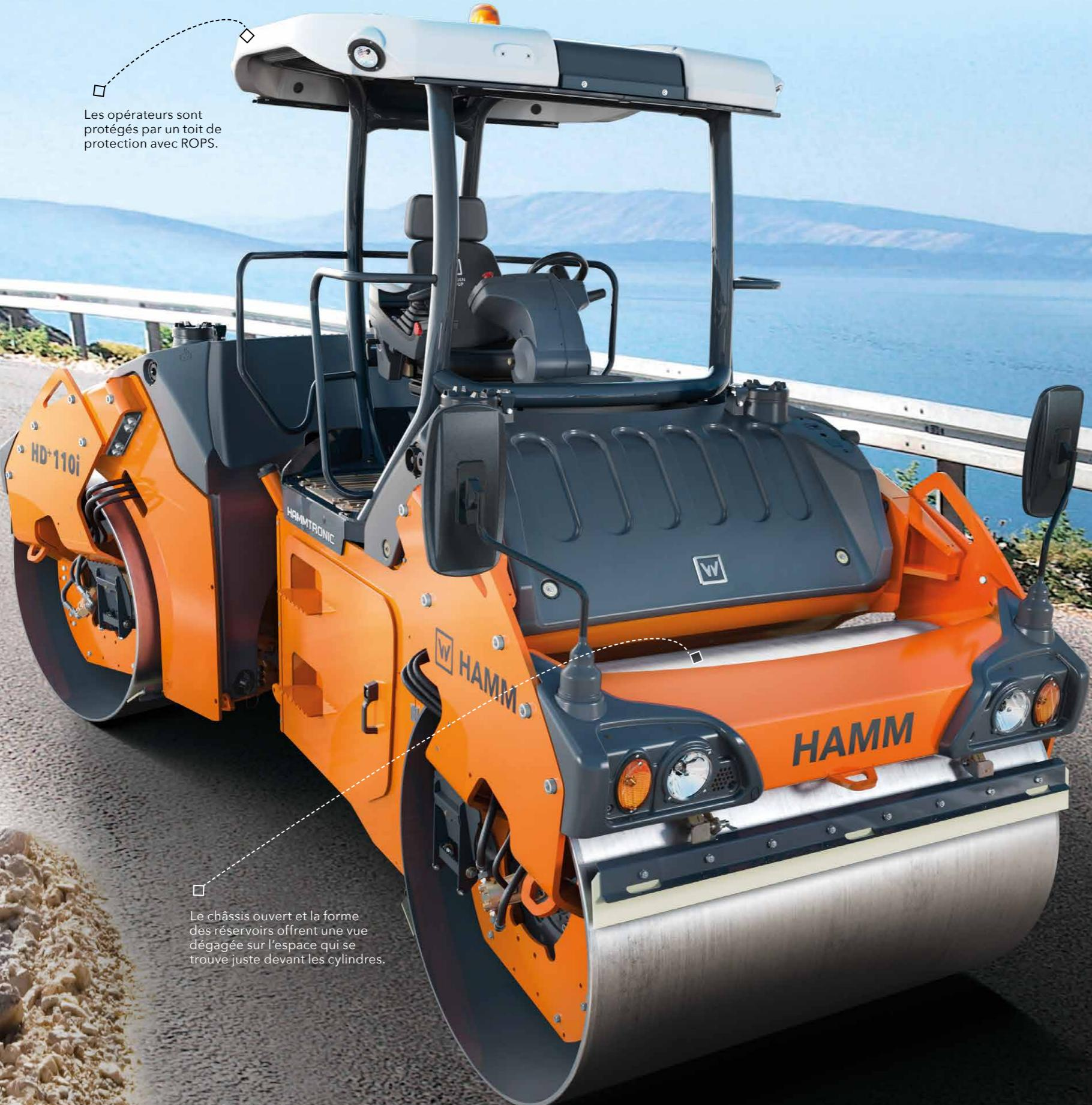
Les opérateurs sont protégés par un toit de protection avec ROPS.
