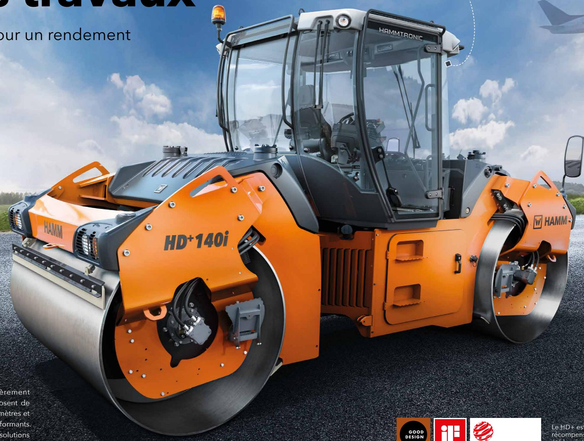
Les rouleaux de la série HD+ sont entièrement conçus pour maximiser le rendement : ils disposent de réservoirs volumineux, de cylindres à grands diamètres et de systèmes d'entraînement et de vibration performants. Grâce à Hammtronic et à de nombreuses autres solutions intelligentes, les machines HD+ sont très économies. Ces rouleaux sont ainsi la solution idéale pour un compactage efficace de grandes surfaces.
