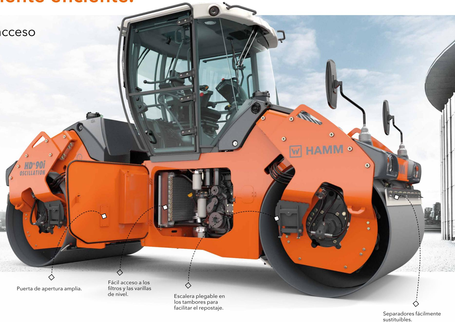
La serie HD+ posibilita un mantenimiento rápido y sencillo, la mejor receta para garantizar el mantenimiento regular del rodillo.
