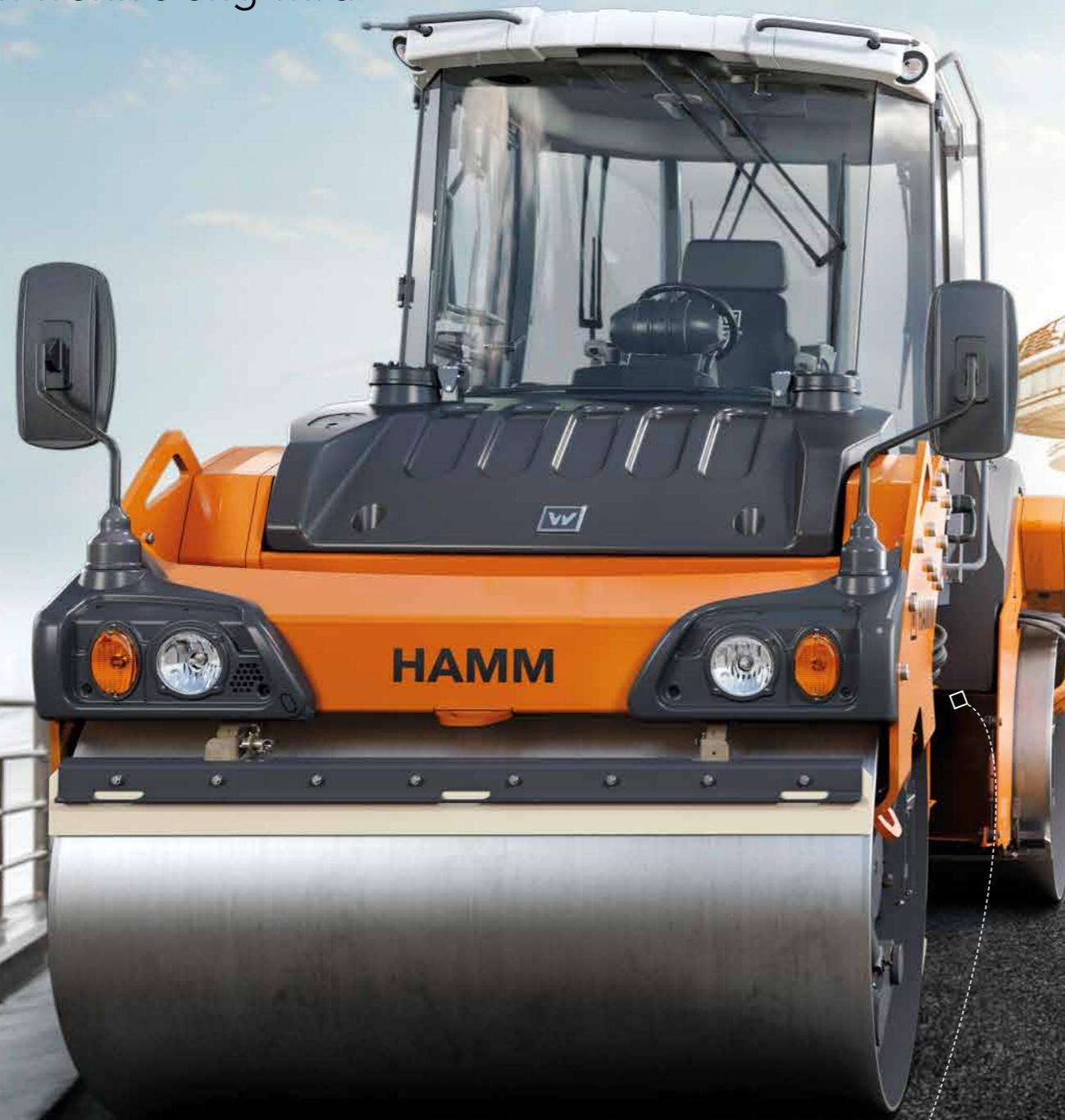
Für knickgelenkte Walzen ungewöhnlich: großer Spurversatz für eine präzise Kantenbearbeitung.
