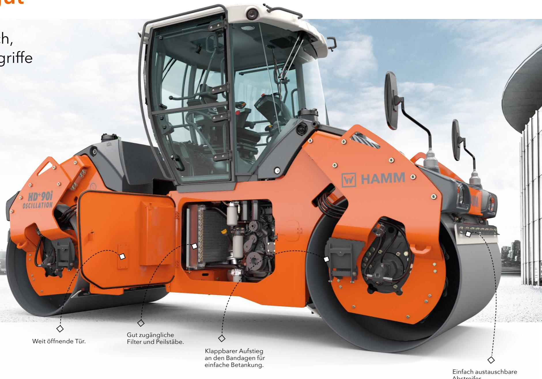
Die HD+ ermöglicht schnelle und einfache Wartung - das beste Rezept dafür, dass die Walze regelmäßig gewartet wird!
