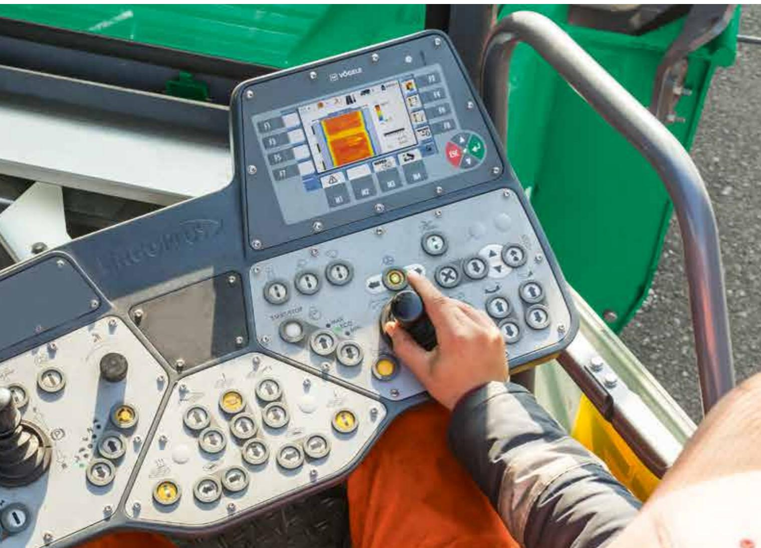
**Der Fertigerfahrer** ist über das ErgoPlus 3 Display mit dem Baustellen-Modul verknüpft. So verfügt er jederzeit über aktuelle Informationen zur Baustelle und zum Baufortschritt. Mit Hilfe von übersichtlichen und leicht verständlichen Anzeigen erkennt er unmittelbar eventuelle Plan-Ist-Abweichungen.
