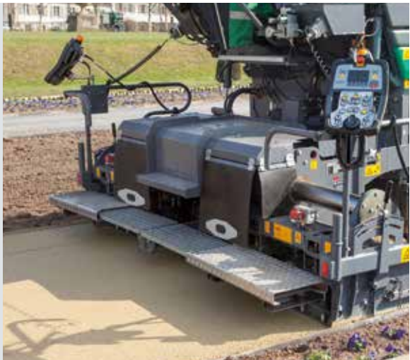
AB 340 V con extensiones mecánicas de 25 cm
