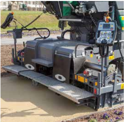
AB 340 V con extensiones mecánicas de 25 cm
