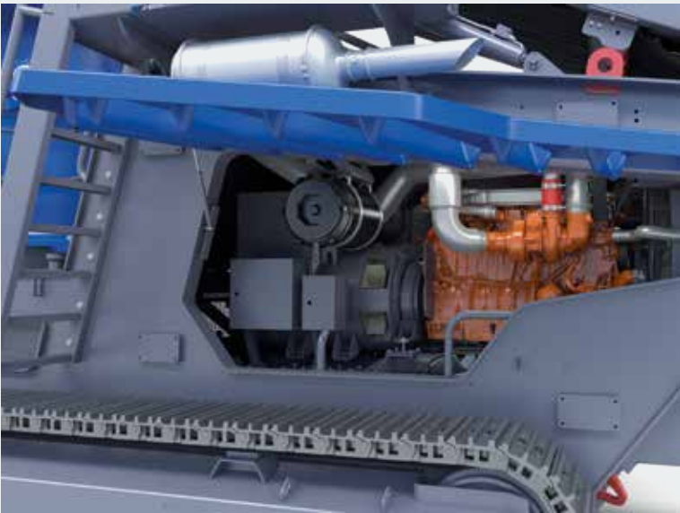
> MCO 110(i) PRO – accès confortable au compartiment moteur, possibilité de faire le plein depuis le sol
