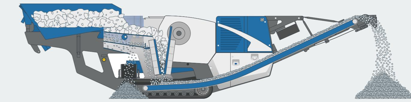
Die Anlage ist einfach und intuitiv zu bedienen, überzeugt mit verschiedenen Regelungs- und Überlastfunktionen und ist äußerst leistungsfähig und effizient im Betrieb. So wird dem Bediener beispielsweise durch das Continuous Feed System die Arbeit erleichtert, da sich die Maschine automatisch um einen gleichmäßigen Materialfluss und damit eine optimale Beschickung des Brechers kümmert. Auch das überarbeitete Design der Aufgaberinne sorgt für einen noch besseren Materialfluss.
